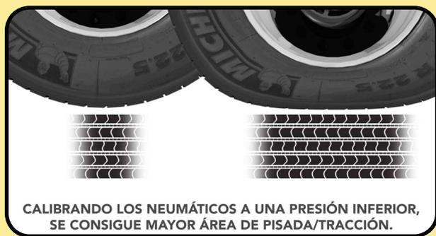
CALIBRANDO LOS NEUMÁTICOS A UNA PRESIÓN INFERIOR, SE CONSIGUE MAYOR ÁREA DE PISADA/TRACCIÓN.
