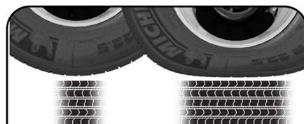
CALIBRANDO LOS NEUMÁTICOS A UNA PRESIÓN INFERIOR, SE CONSIGUE MAYOR ÁREA DE PISADA/TRACCIÓN.
